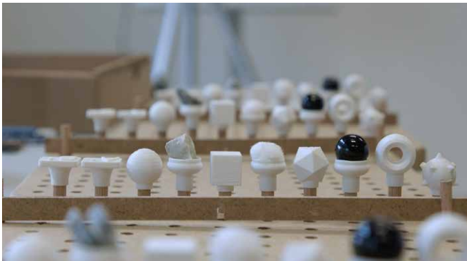
Abb. 9: Die 3D-gedruckten haptischen Stecker nebeneinander
